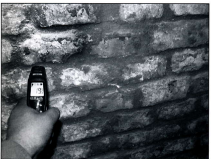
■ 8–9. kép: A szegedi vár hidrofób légpórusos cementhabarccsal fugázott szigetetlen belső falának felületi nedvesség és hőmérséklet mérése
