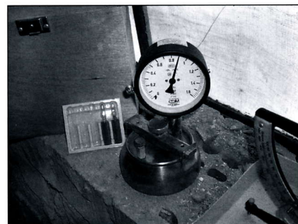
■ 5. kép: Nedvesség tájékoztató mérése a helyszínen CM-módszerrel ■ Photo 5. Informative on-site moisture measurement with the CM method
